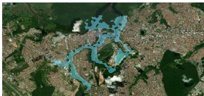
Figura 03: Mancha de inundação a jusante da barragem, Fonte: Arcmap
